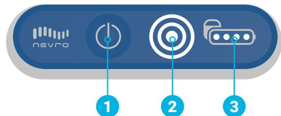
2. Cuando aparece el anillo exterior del círculo en el **indicador de intensidad de señal de la antena**, es que se ha establecido conexión. Cuantos más círculos aparezcan, mejor será la conexión y será menos probable que la carga se interrumpa con los movimientos. Si solo se ilumina el punto central, significa que la conexión es mala y que el dispositivo y el cargador no se han conectado entre sí.
